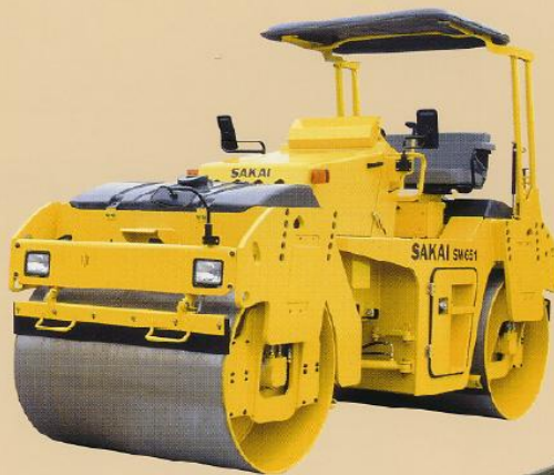
SW651 Rodillo en Tandem Peso Neto 7.1 ton (15.650 lb.)
