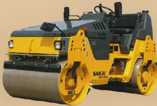
SW352 Tipo rodillo doble Peso Neto 2.9 ton/1.2 m (6.480 lb. /47")
