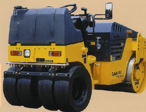
TW352 Tipo combinado Peso Neto 2.6 ton/1.2 m (5.820 lb. /47")
